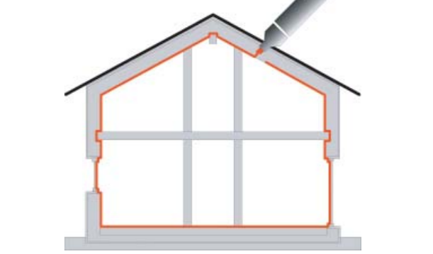
Obr. 5 Neprůvzdušnost zajišťuje spojitá vzduchotěsnicí vrstva, která musí být precizně vyhotovena. Kromě tepelných ztrát tato vrstva chrání konstrukce před vlivem vlhkosti, která se šíří přes netěsnosti.
